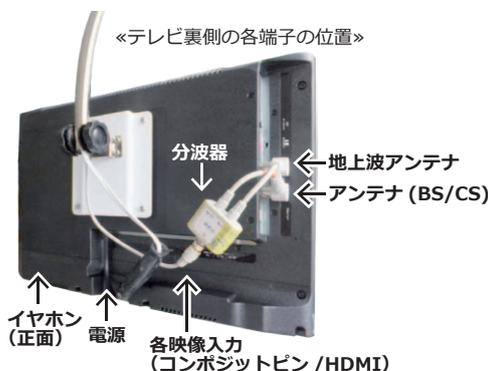
アンテナは「分波器」を介して2本に分岐させます。それぞれ、「地上」「BS/CS」各端子に接続
