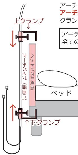
アーチパイプの上・下クランプ間を動かし、**アーチパイプが垂直**の状態ヘッドパネルへ挟み、クランプのグリップボルトを全てしっかり締めます。
