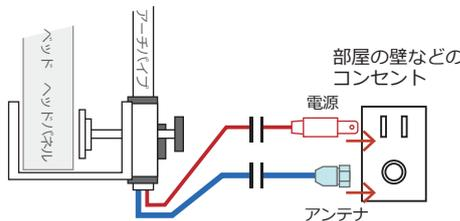
※パイプからケーブル長さで足りない場合は**電源・アンテナ各ケーブルを用意頂き、継足し延長**下さい。
