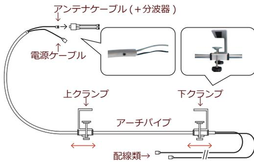
設置作業を楽に行って頂けるように、「アーチパイプ」に「配線類」「上・下クランプ」を予め当社にて組み込み済みの状態でお渡しいたします。
