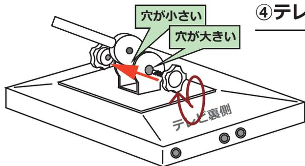
アーム先端の穴と、テレビ取付用裏金具の穴がまっすぐ通るように合わせてから、ボルト側を「穴が大きい」側から差し込みます。「穴が小さい方」がネジ構造になってますので小さい方に届くまで押し入れてから、しっかりと締めてから、ナット側を締め合します。
