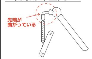
吊り金具(青枠の箇所)の向きを調節します。 写真の方向から見て手前に回転させてテレビ取付部を下に向けます。
