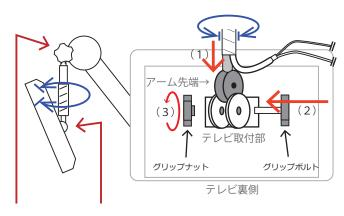
吊り金具は約1回転しか回らないようになっています。 画面を左右平等に回転できる向きで設置してください。
