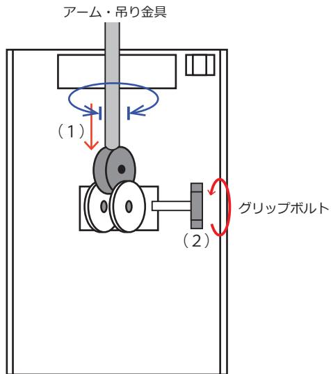
1. ミラー（鏡）がアームの内向き・上下向きが正しい事を確認してアーム先端にミラー取付部にはめます。
