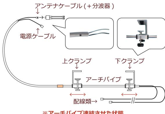
設置作業を楽に行って頂けるように、「アーチパイプ」に「配線類」「上・下クランプ」を予め当社にて組み込み済みの状態でお渡しいたします。
