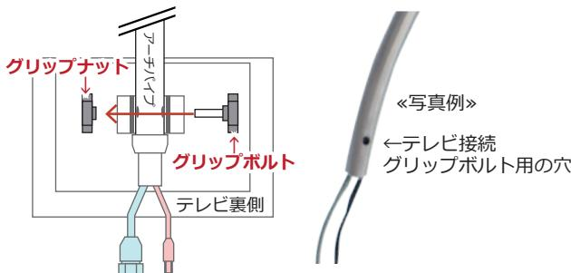
「アーチパイプ先端側面の穴」に「テレビ裏側の取付部」を穴の位置を合わせてグリップボルトを通してテレビを取付けます。
